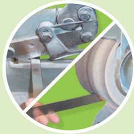
Zum Kürzen der Rückenstäbe werden von der gemessenen Rückenhöhe 5 cm abgezogen = ergibt die Länge der benötigten Federstahlstäbe 5. **Gekürzte Schienen abrunden.**
